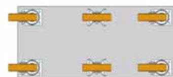
Четыре поворотных и два фиксированных ролика одинаковой высоты
