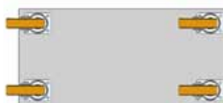
Четыре поворотных ролика одинаковой высоты
